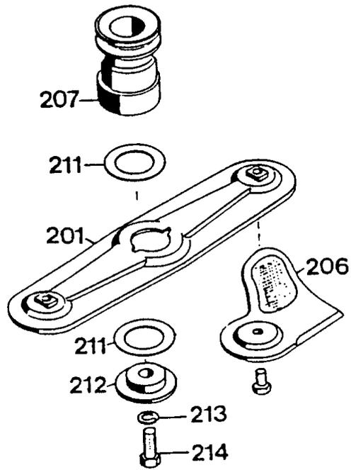
**Gerät: 2.42 T (Zwischenring, Motor, Messerbalken)**
